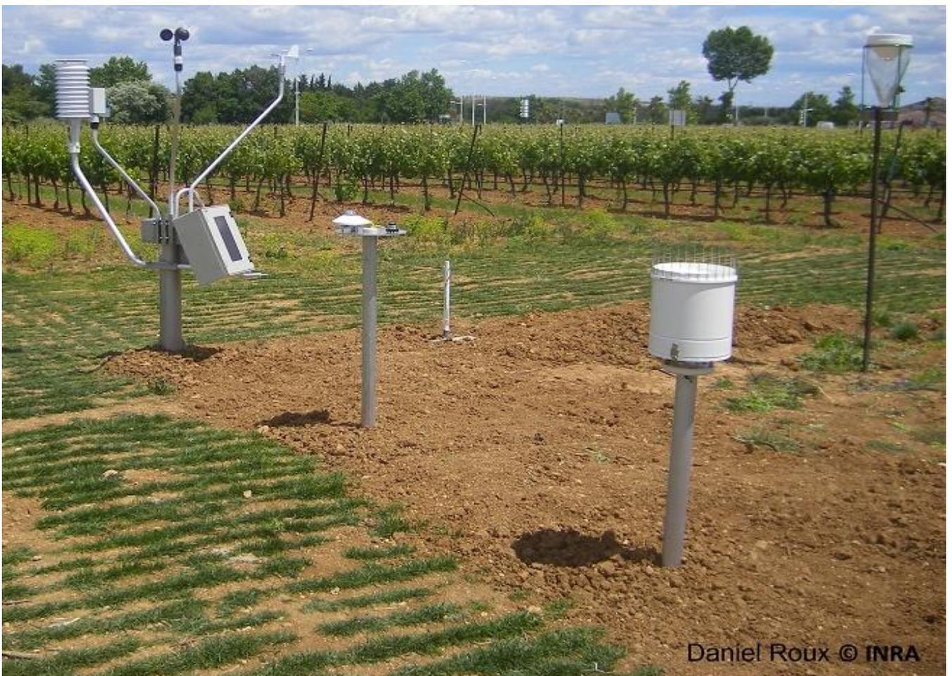
CimAWS-500 est une station météorologique automatique conçue pour les réseaux d'observation météorologiques, synoptiques et climatologiques supportant tous les capteurs nécessaires et la mesure du vent à 10 m en conformité avec les recommandations de l'Organisation Mondiale de la Météorologie pour la qualité des mesures et la disposition des capteurs.
